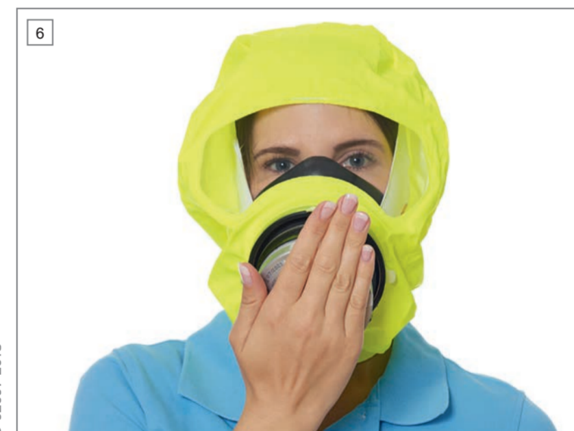
Controleer de zit van het binnenmasker door de voorste filteropening met uw handpalm af te dekken. Wanneer geen onderdruk gegenereerd wordt, verschuift u het binnenmasker om een goede aansluiting over neus en mond heen te bewerkstelligen.
