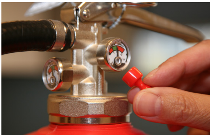
Demonstratie van de magneettest bij de dubbele manometers
